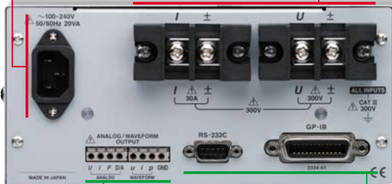
Hinterseite des 3334-01 mit eingebauter GP-I-Schnittstelle
