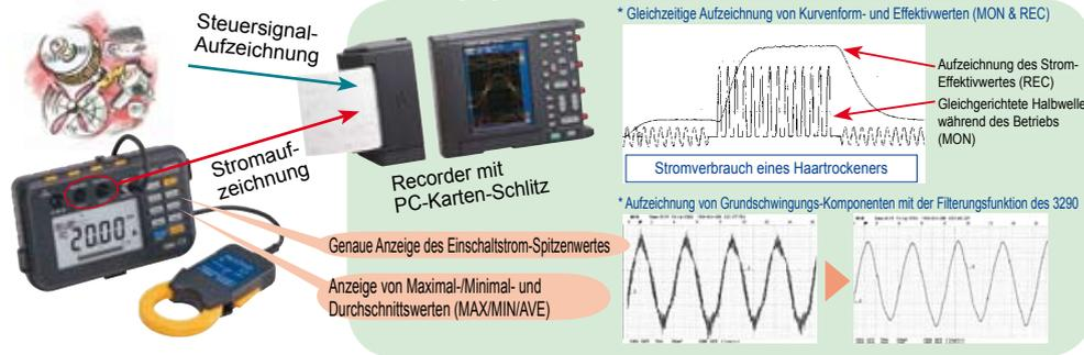
Messdaten können im Einsatz auf der PC-Karte gespeichert und später auf einem PC hinterlegt, analysiert und verarbeitet werden.
