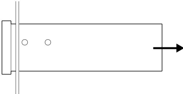
1. Gerät in den Frontplattenausschnitt bis zum Anschlag einschieben.
